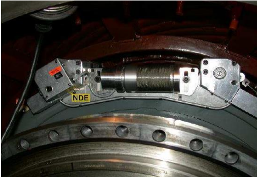
Inspection robotique du stator de l'alternateur
