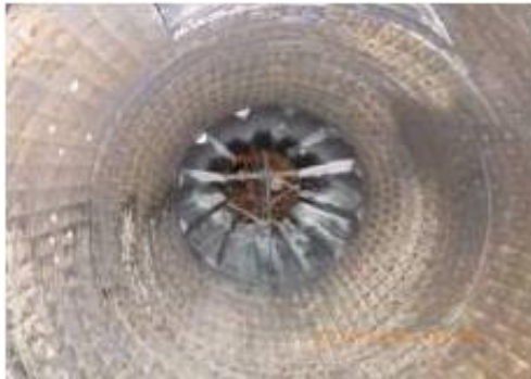
Inspection robotique du stator de l'alternateur
